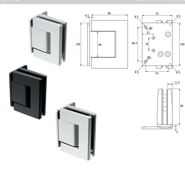
Cerniera chiudiporta oleodinamica con regolazione angolare Versione vetro/muro, piastra laterale Rotazione su cuscinetti a sfera di precisione «heavy duty» Apertura a +90° e -90° Chiusura automatica da 80° Regolazione della velocità di chiusura Regolazione angolare ± 10° Testata 500.000 cicli di apertura Utilizzabile solo per porte interne Realizzata in lega di alluminio ad alta resistenza
